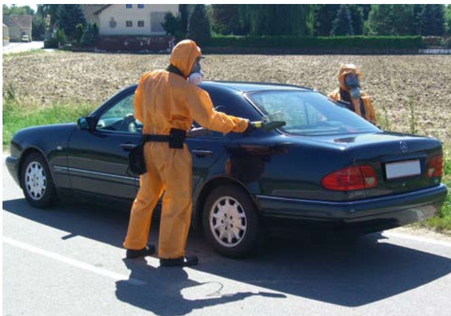
La détection de sources de rayonnement sur les véhicules à l'aide d'appareils à main requiert le port de vêtement de protection pour les inspecteurs.
