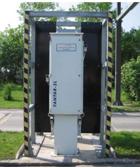
Un appareil installé à poste fixe détecte automatiquement la présence de matières radioactives.
