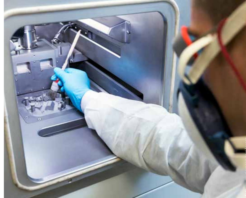
Una vez finalizada la impresión, se quedan grandes cantidades de polvo metálico que deben retirarse con cuidado.
