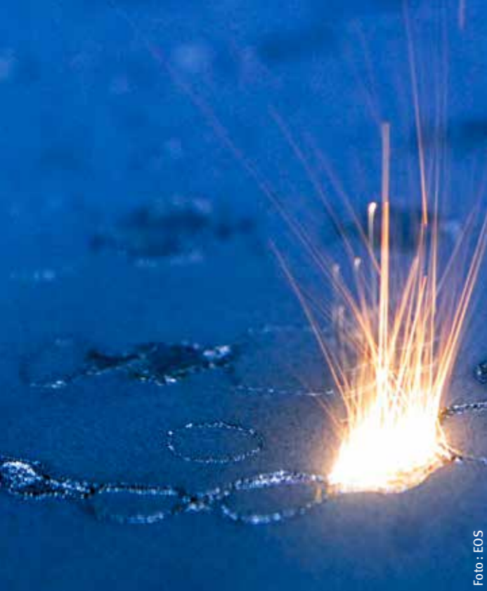
El proceso de sinterizado por láser directo de metal (LMD) utilizado para las coronas y puentes dentales.
